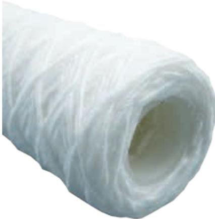
PPCB Wickelkerzen werden aus Garnen hergestellt die um einen zentralen Stützkern gewickelt werden. Durch das diagonale bzw. kreuzförmige Wickelmuster bietet die Wickelkerze eine eng verflochtene Tiefenfilter-Struktur und dadurch eine hohe Schmutzaufnahmekapazität.
