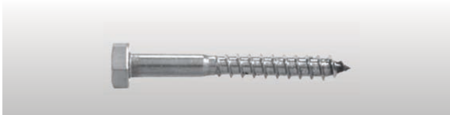
Шуруп по дереву с шестигранной головкой («глухарь») Материал: сталь 3.6, 4.6, нержавеющая сталь A2, A4
